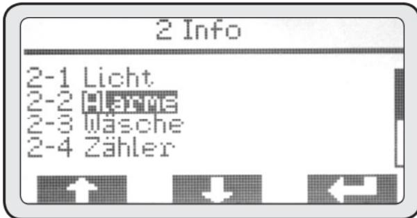
Scrollen Sie mit den Tasten (PD1) und (PD2) alle im Verlauf der Fehlermeldungen registrierten Alarme. Beachten Sie dabei, dass der zuerst angezeigte Alarm in zeitlicher Reihenfolge bezüglich des Auftretens der Letzte ist. Die maximale Speicherkapazität liegt bei 20 Alarmen. Wird diese Anzahl überschritten, werden die älteren Alarme gelöscht und durch die neueren überschrieben.
